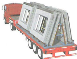
构件侧立放置
