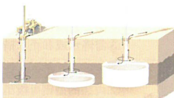
高压旋喷桩止水帷幕
