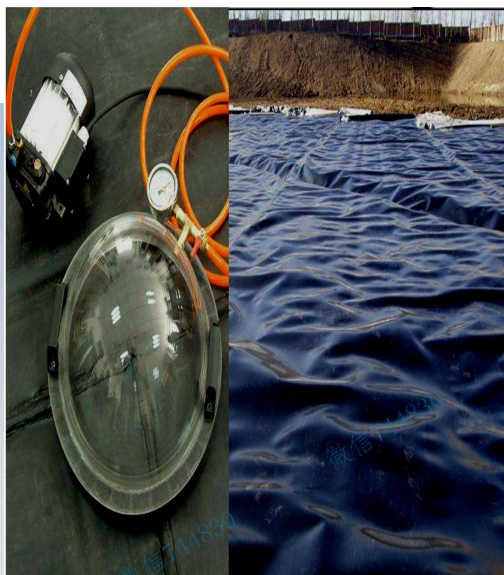
图 1K416012-6 双缝热熔焊接气压检测示意图
